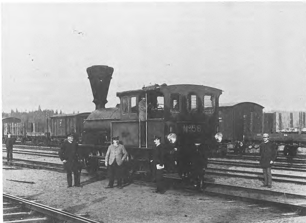
Rautatieliikenteen kasvaessa tuli tarpeelliseksi saada eri työtehtäviin ”erikoistuneita” vetureita. Tämä taas lisäsi veturimiesten ammattitaitovaatimuksia. Kuvassa Suomen ensimmäinen varsinainen vaihtoveturi n:o 56 Riihimäen ratapihalla. Keskellä oleva pönäkkä herra on Riihimäen asemapäällikkö Anton Öller. Rautatiemuseo.
